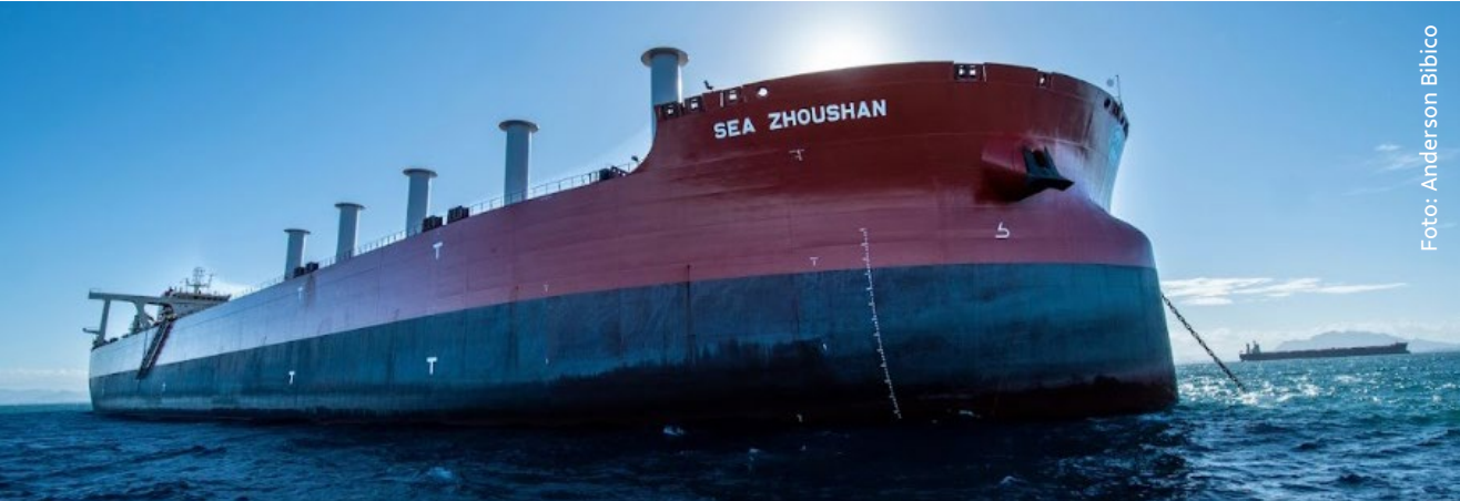
Porto de Tubarão recebe o primeiro navio mineraleiro de grande porte do mundo equipado com sistema de velas rotativas (rotor sails). O navio Sea Zhoushan é um Guaibamax.
