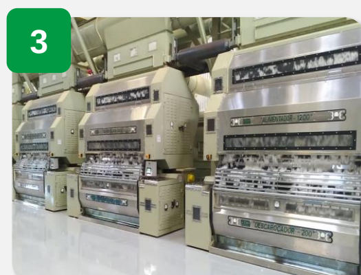
Alimentador / Descaroador Separa a Pluma do Caroço
