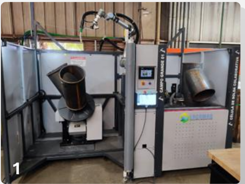
Equipamento robotizado para solda de canalização
