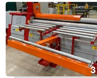
Equipamento de calandragem (conformação de chapas metálicas)
