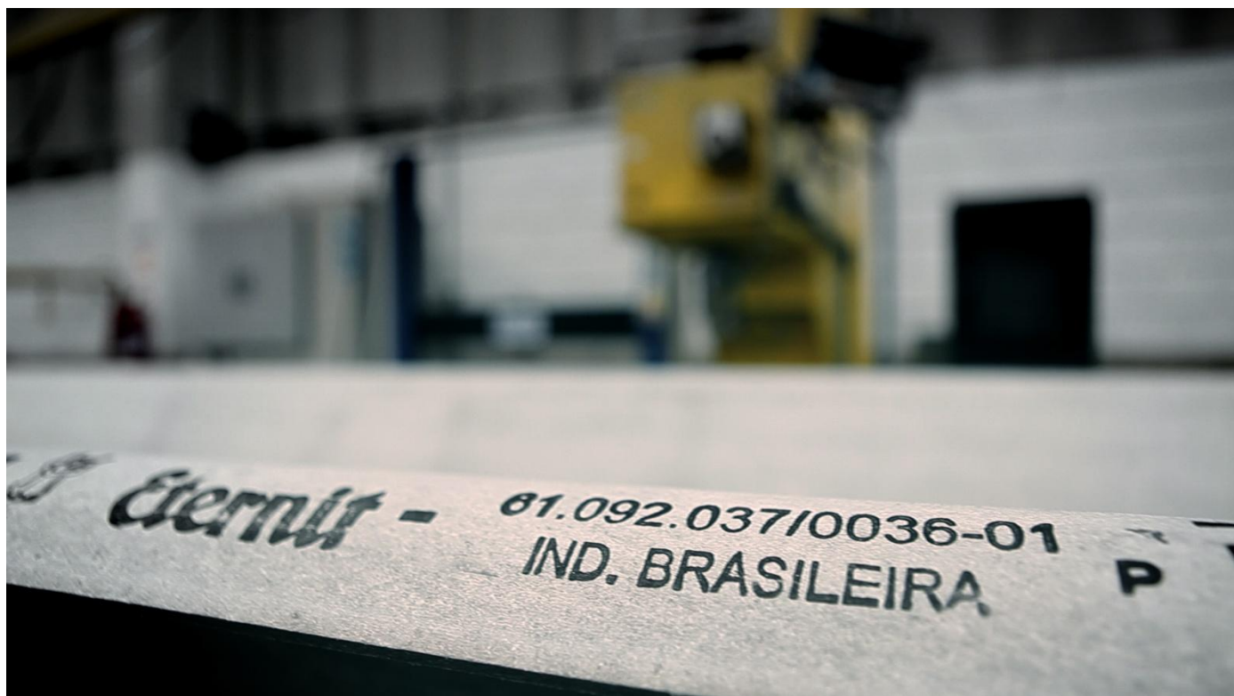
Telha de fibrocimento produzida pela Eternit – identificação conforme marcação de fábrica
